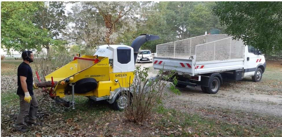
Le broyage permet de réduire la masse des déchets végétaux du jardin et de les valoriser. Les branches présentées à l'entrée du broyeur sont déchiquetées et transformées en copeaux de bois.
